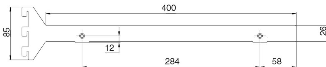
Если толщина задних вертикальных панелей 18 мм, то глубина полки составляет 400 мм, как указано на схеме выше. Если панели 16 мм., то глубина полки – 402 мм.
