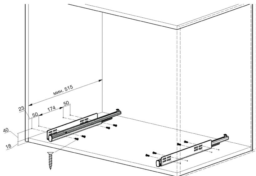
Минимальная глубина каркаса до задней стенки 515 мм.
