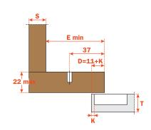
Варианты решений для терминальных петель с различными по высоте ответными планками. Н - высота ответной планки
