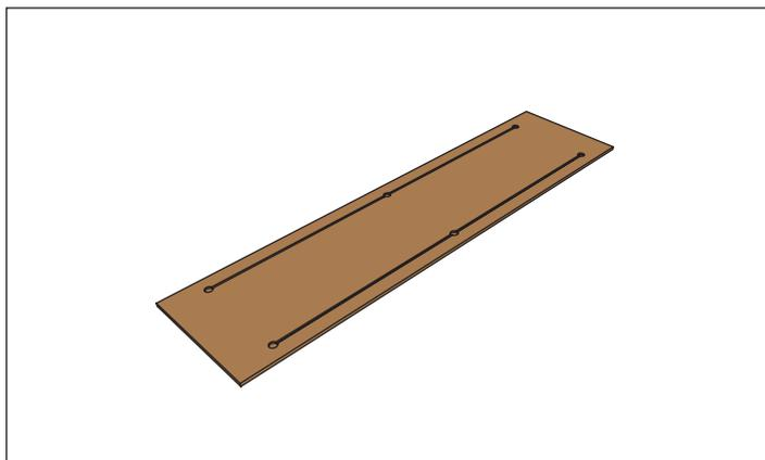
**ШАГ 1.** Фрезеровка фасада под установку выравнивателя.
