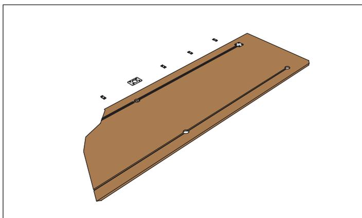
**ШАГ 3.** Устанавливаем регулировочную пластину и фиксаторы.
