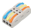
HW.003.042 соединитель клеммный, проход, для 3-х линий, быстрозажимной, сечение провода 0,34-4мм 2 , 32А, 250В
