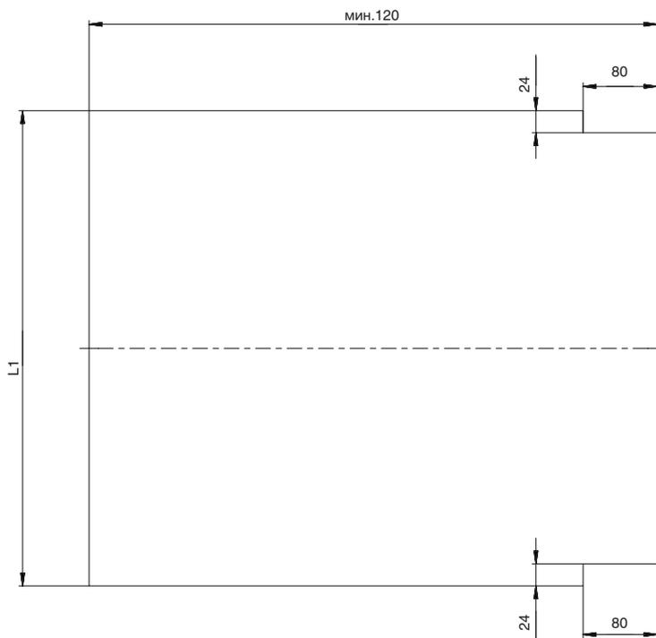
СХЕМА РАСЧЕТА И ПРИСАДОЧНЫЕ РАЗМЕРЫ ФАСАДА
