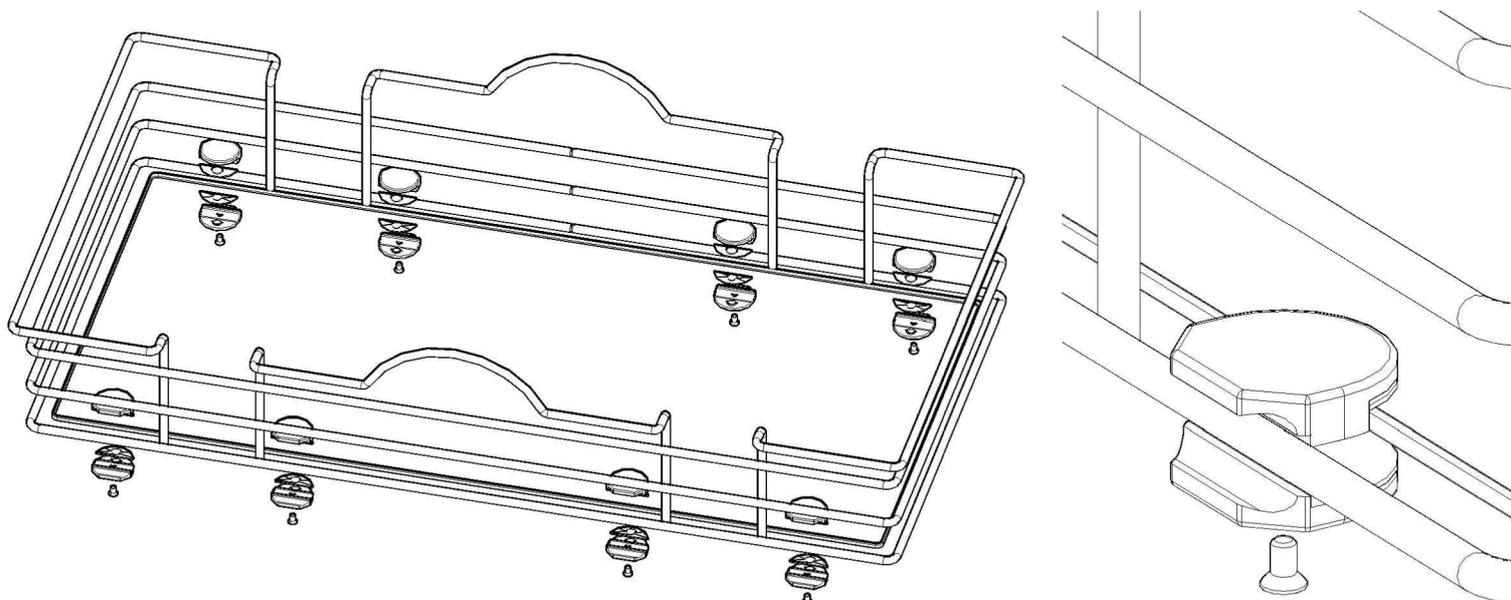
**4** ОКОНЧАТЕЛЬНЫЙ МОНТАЖ ПОЛКИ (ПОСЛЕДОВАТЕЛЬНОСТЬ УСТАНОВКИ)
