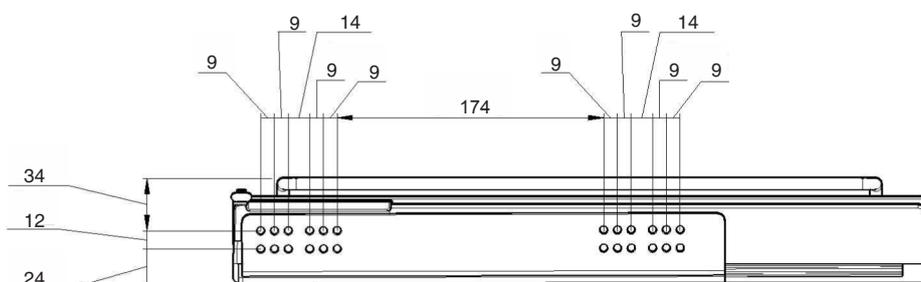
**2** СХЕМА ПРИСАДКИ НАПРАВЛЯЮЩИХ НА БОКОВУЮ ПАНЕЛЬ КАРКАСА
