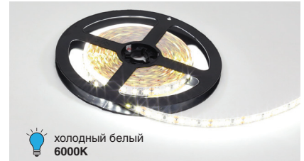
M-E.2835.120.12.20.CW.03 Лента светодиодная SMD2835, 120 LED/м, 12Вт/м, 12В, 960-1080Лм./м 5000x8 мм, IP 20, 6000K
