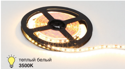
M-E.2835.120.12.20.WW.01 лента светодиодная SMD2835, 120 LED/м, 12Вт/м, 12В, 960-1080Лм./м 5000x8 мм, IP 20, 3500K
